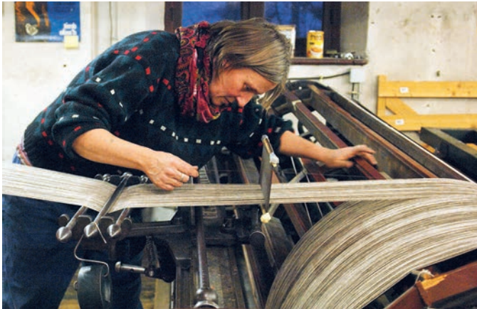
Die Kette des Webstuhls wird vorsichtig abgespult.
